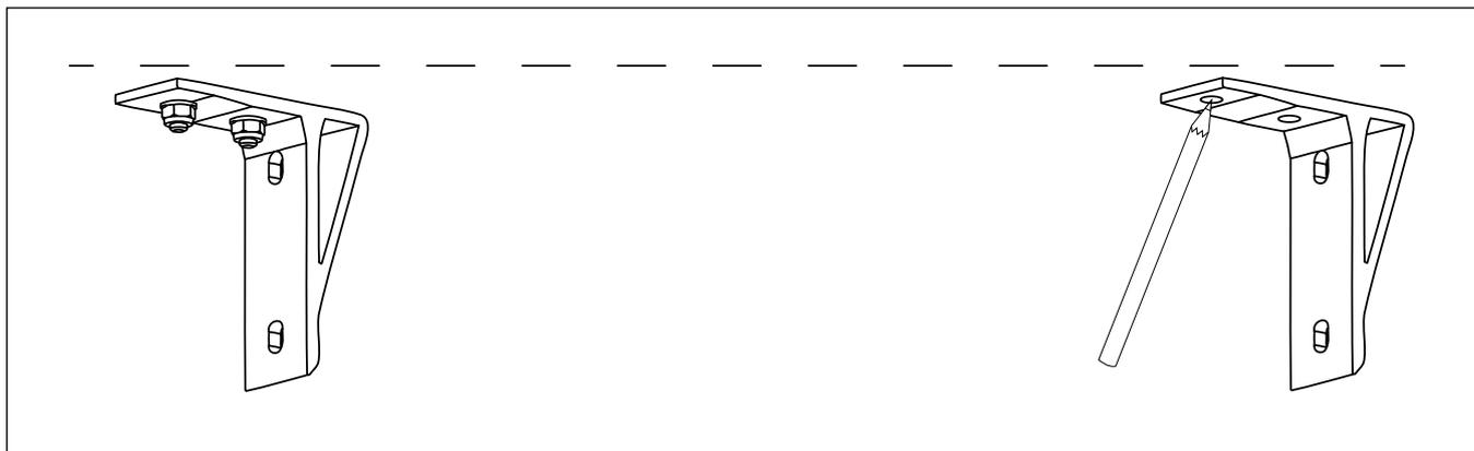
Bohrlöcher mit einem geeigneten Bohrer herstellen.
